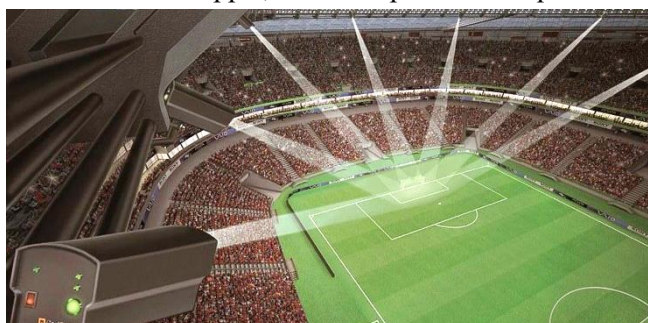
La goal-line technology prevede l'installazione di 7 telecamere che stabiliscono con precisione assoluta l'entrata del pallone nello specchio della porta
